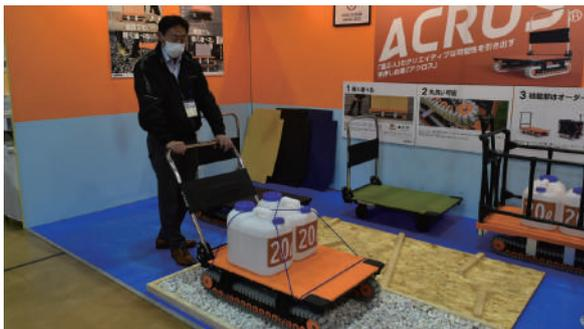
（写真1）クローラータイプの手押し台車「アクロス」
